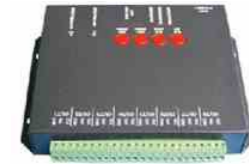
EML-8000C Control: ≤8*1024pixels (TTL信号) ≤8*512pixels(DMX512) (注: 可多台级联脱机控制, 播放内容存放在SD卡中)
